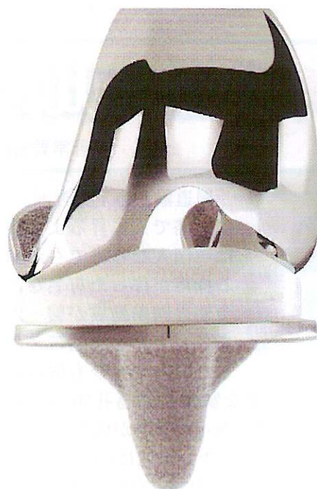
▲実際に用いられている人工膝関節の1例 (上下はコバルトクロム合金製、中央が超高分子量ポリエチレン製)
